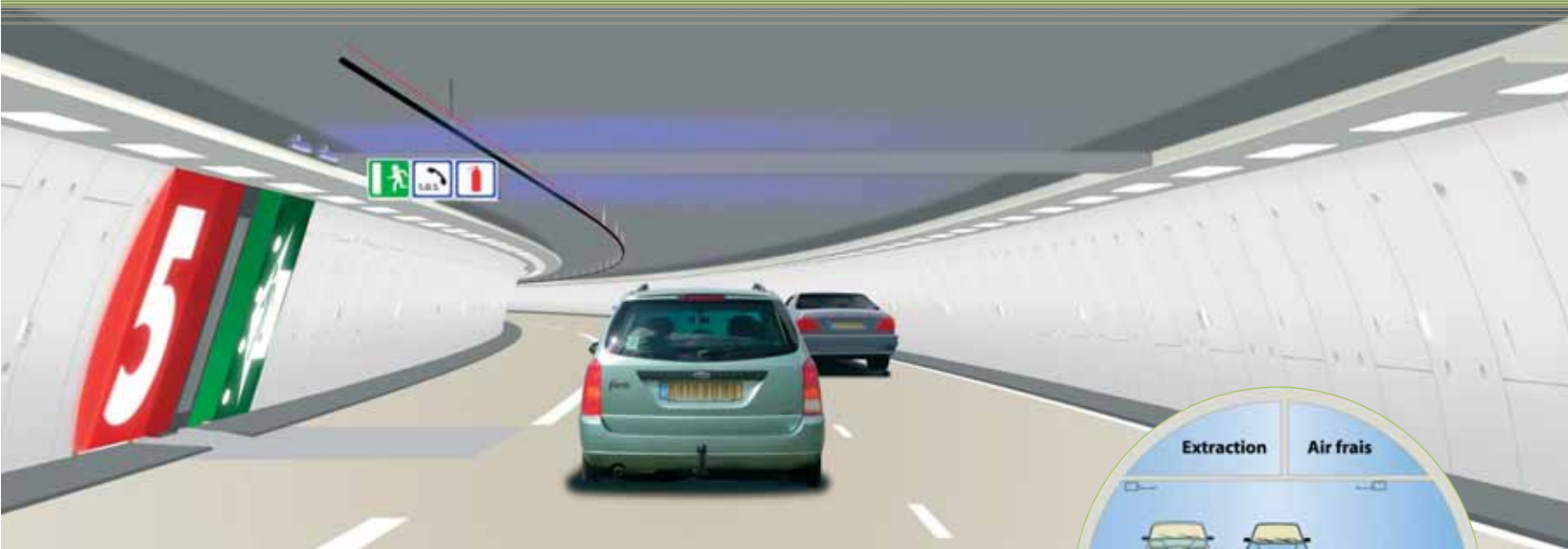
L'utilisation d'enrobés clairs pour la chaussée du futur tunnel de l'A86 contribuera au confort visuel des conducteurs et à la sécurité.
