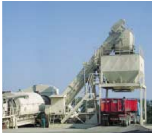
Vue générale du poste d'enrobage à double tambour.
