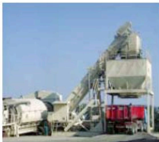
Vue générale du poste d'enrobage à double tambour.
