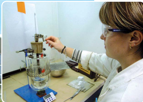
Réalisation d'un essai de fragilité Fraass.
