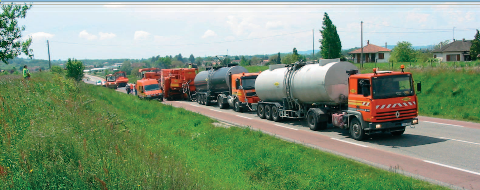
Unité de retraitement d'enrobé en place à l'émulsion.
